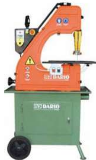
На фото: агрегат SN33, смонтированный на мобильной подставке
