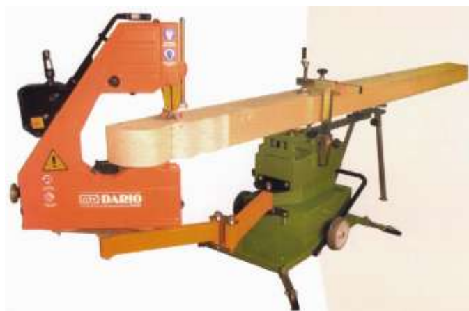
SET 1500: пильная головка SV3 MINI на шарнирной опоре + подвижная тележка + кронштейн с винтовым прижимом + опорная стойка
